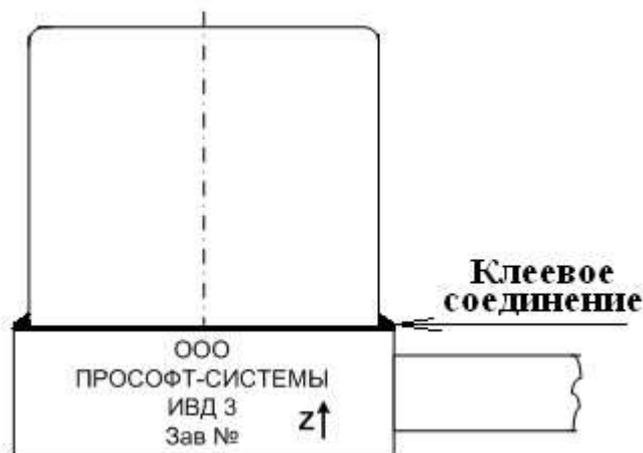
Рисунок 2. Схема пломбировки датчика от несанкционированного доступа.
