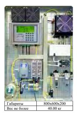
Газоанализатор (ГА) "МАК-2000" с блоком термостатирования сенсоров (см.рис.1) является промышленным автоматическим стационарным непрерывно действующим одноканальным прибором с принудительной подачей анализируемого газа. Блок термостатирования сенсоров позволяет эксплуатировать ГА "МАК-2000" во взрывобезопасных помещениях с температурой в месте установки до 55-60С, т.к. поддерживает в этих условиях температуру сенсоров при 25+/- 0,2 С.
